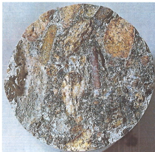
Obr. 8: vývrt V2 – koncová lomová plocha
