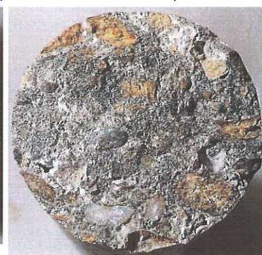
Obr. 10: vývrt V3 – koncová lomová plocha
