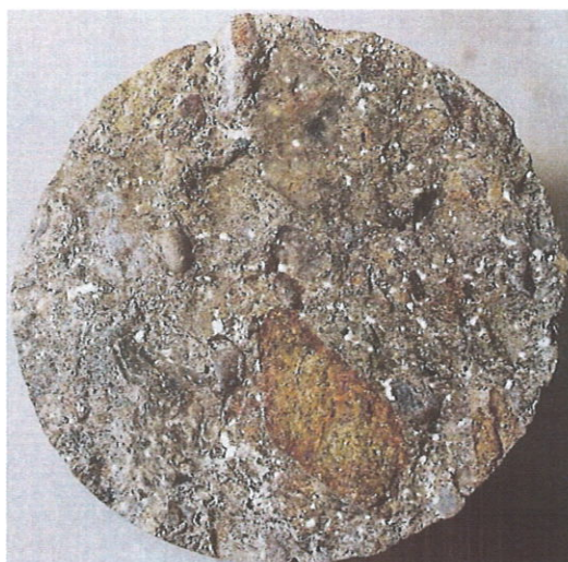
Obr. 8: vývrt V2 – koncová lomová plocha
